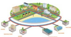
Mutualisation d'un ou plusieurs captages géothermiques pour desservir plusieurs bâtiments via un réseau de distribution (boucle). Chaque bâtiment est équipé d'une PAC pour chauffer/rafraîchir son réseau interne.
